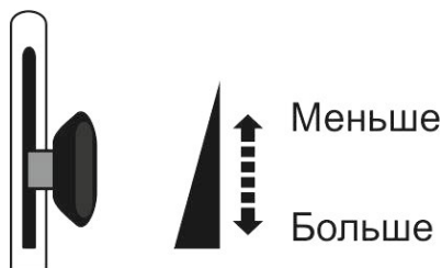
Рисунок 3.11. Рычаг регулировки подачи топлива («ручной газ»)
